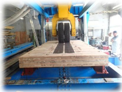
CLT床版の輪荷重走行試験
