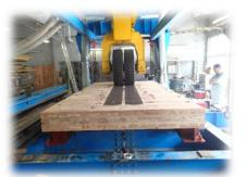
CLT 床版の輪荷重走行試験
